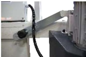
Einhebel Kippvorrichtung auf Kantenschleife
