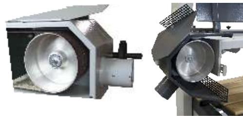
Absaugstutzen links und rechts
